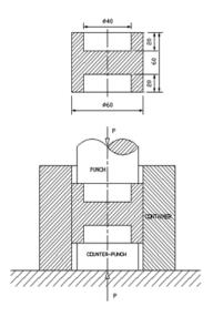
FIGURE 14. H-forging in die
