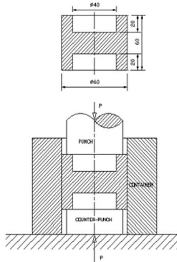
FIGURE 14. H-forging in die
